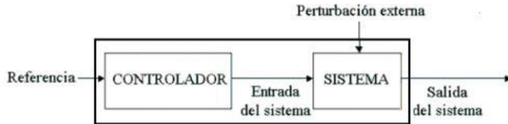
Figura 17 Sistema de control en lazo abierto
