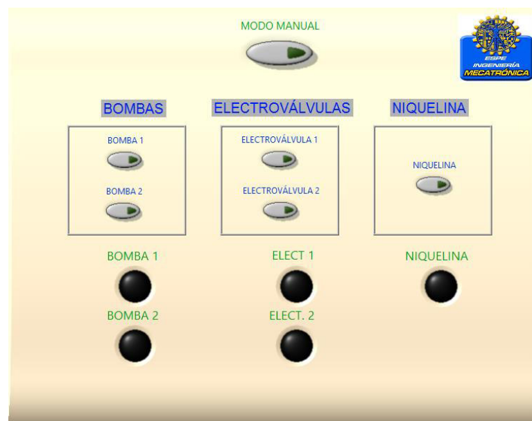
Figura 130 HMI sección modo manual
