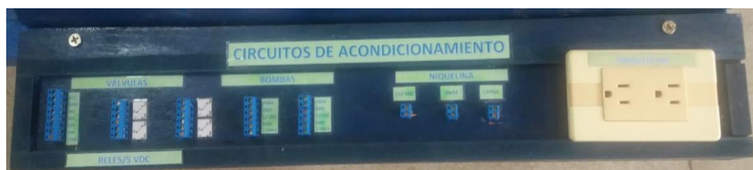
Figura 82 Panel circuitos de acondicionamiento instalado en el módulo
