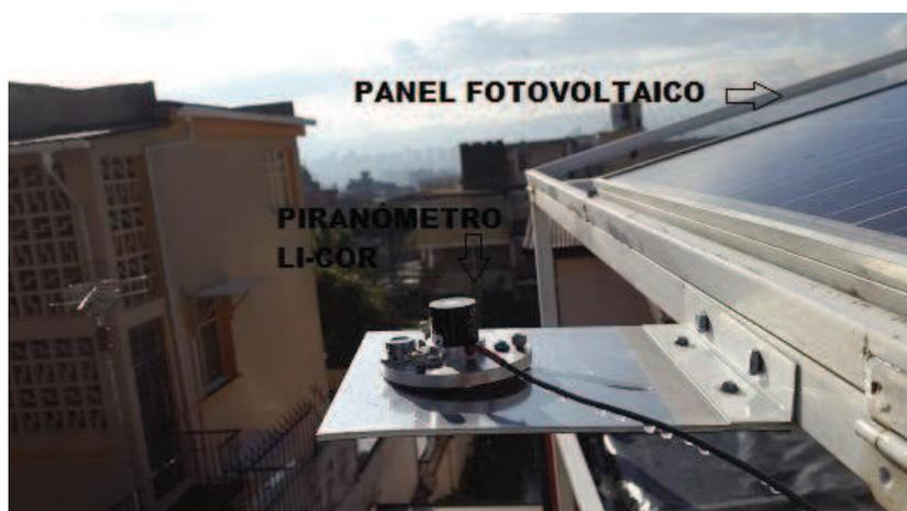
**Figura 56.** Piranómetro LI-COR 200 SA instalado
