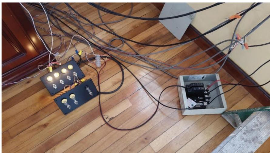
**Figura 68.** Carga resistiva acoplada al panel fotovoltaico SUNSET PX1206
