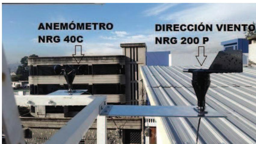
**Figura 48.** Anemómetro NRG40C y Veleta dirección viento NRG 200P instalados.
