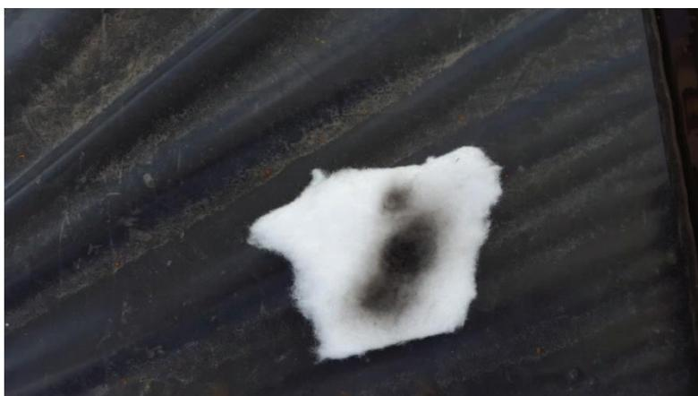
**Figura 71.** Pieza de algodón después de efectuar la limpieza de una pequeña sección del panel fotovoltaico
