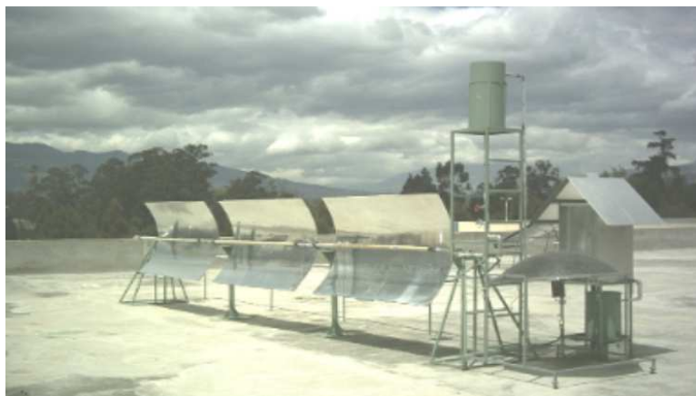
Figura 31: Esquema Concentrador Cilíndrico Parabólico
