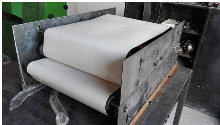
Figura 32 Montaje de Bandas y paredes de fusión
