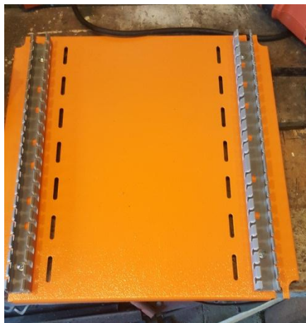
Figura 49 Doble fondo del tablero
