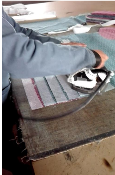
Figura 93 Fusonado manual con plancha industrial
