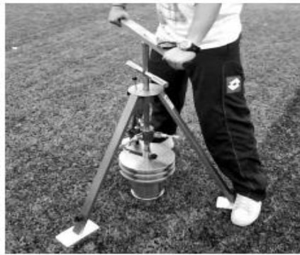
Figura 5. Máquina de ensayo de tracción rotacional.
