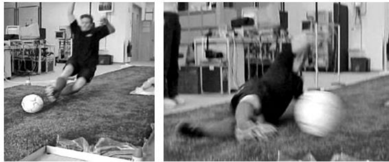
Figura 7. Ensayo de abrasión de la piel sobre césped artificial.
