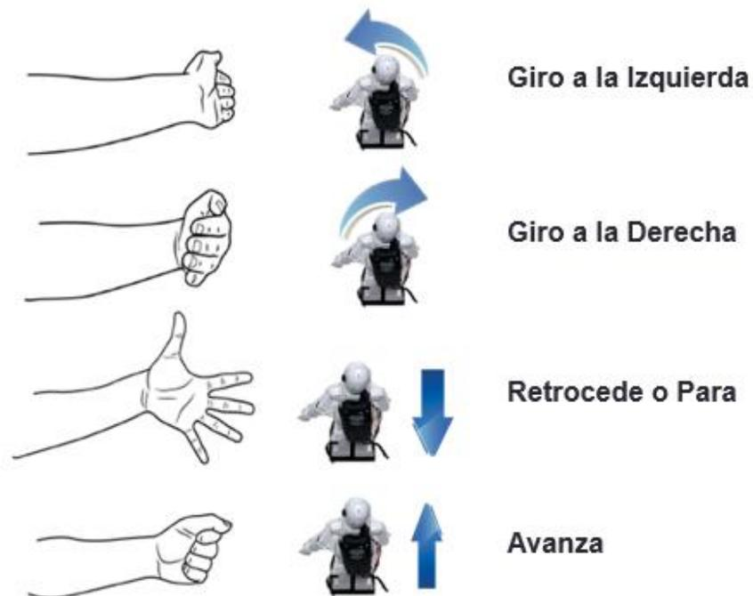
**Figura 33.** Movimientos de la mano y acción a ejecutar por parte del robot
