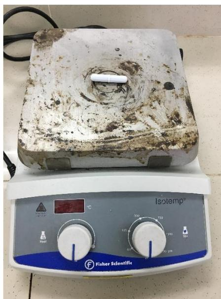
Figura 37 Agitador Magnético Fisher Scientific
