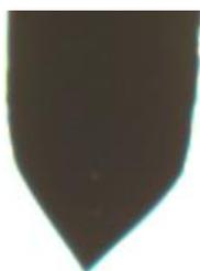
Figura 42 Cono de Taylor estable, solución utilizada 13% de PVP. Imágen obtenida mediante una cámara analoga CCD.
