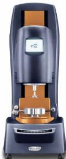
Figura 35 Reómetro TA HR-2
