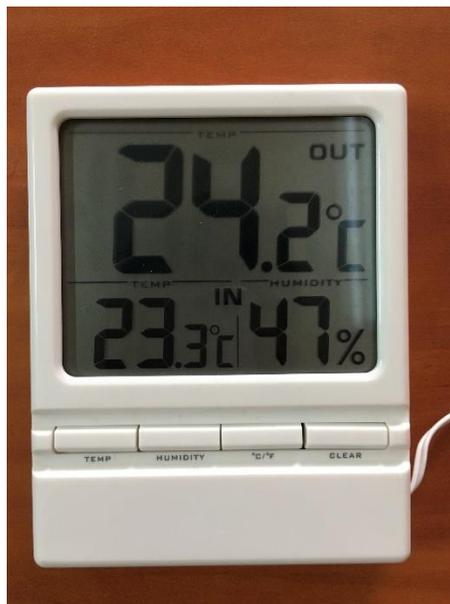
Figura 39 Termohigrómetro
