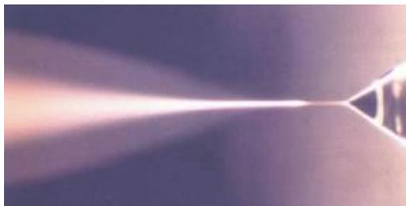
Figura 10 Fotografía Modo de Funcionamiento Cono – Chorro único. Cono de Taylor estable
