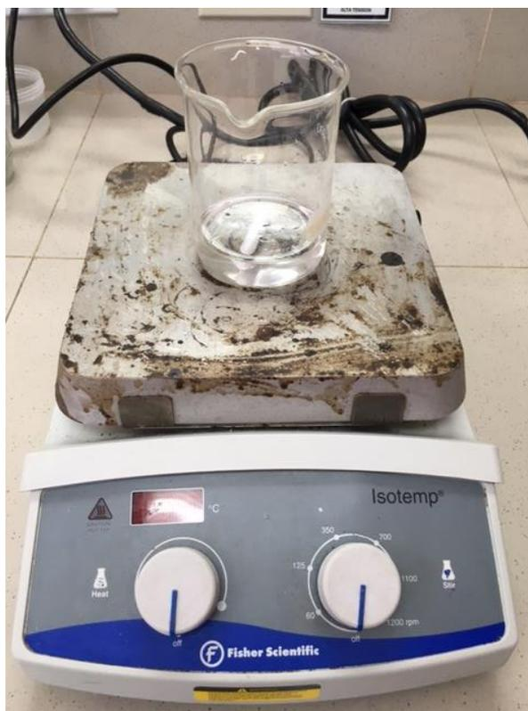
Figura 40 Mezcla PVP y DMF, mediante un agitador magnético.
