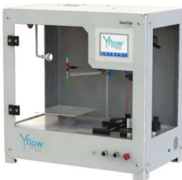
Figura 31 Equipo de Electro spray. Laboratorio de Reología DECEM. Marca YFlow
