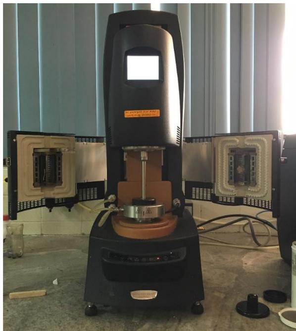
Figura 51 Reómetro TA HR-2 – Laboratorio de Reología.
