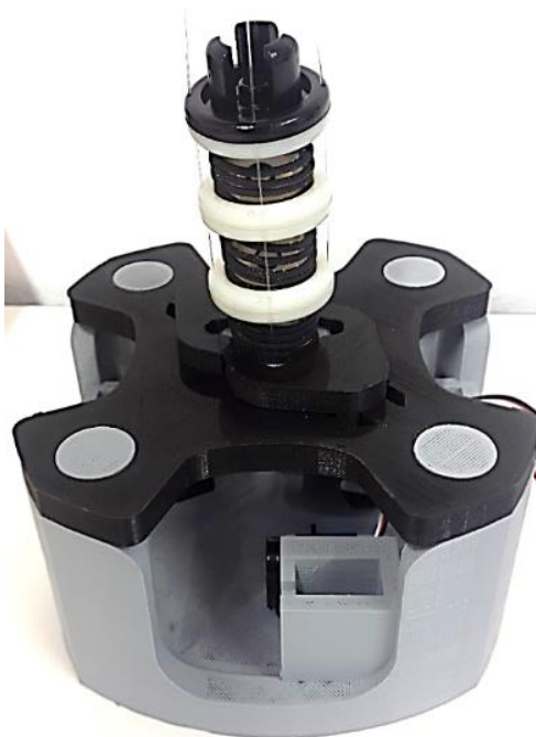
Figura 50 Montaje de la estructura con 4 Módulos T
