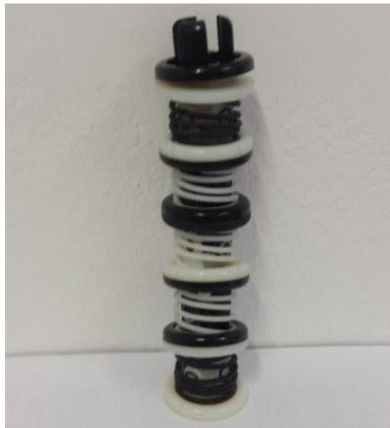
Figura 46 Estructura Híper-redundante del robot con ocho módulos de T.
