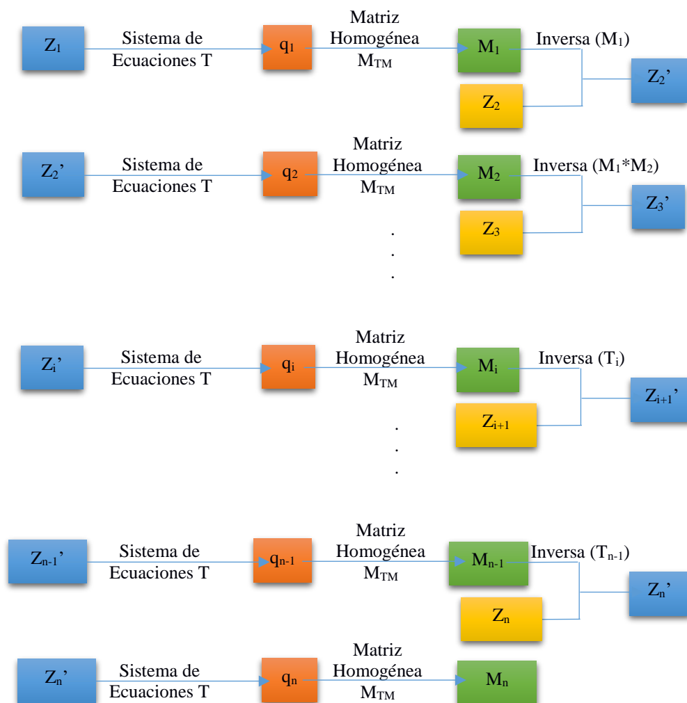
Figura 32 Algoritmo de obtención de matrices de transformación modulares \mathbf{M} a través de la obtención de sistemas de referencia locales \mathbf{Z}'
