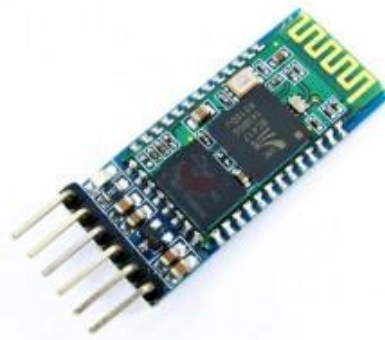
Figura 27 Módulo Bluetooth HC-05
