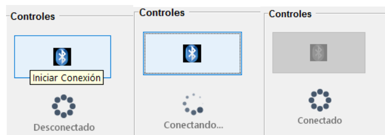
Figura 53 Funcionamiento de conexión Bluetooth
