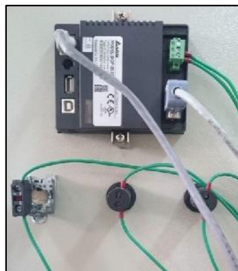
Figura 137. Conexión luces piloto
