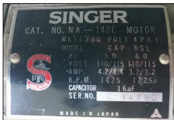
Figura 18. Especificaciones técnicas motor SINGER
