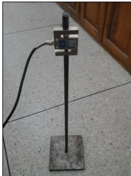
Figura 123. Acondicionamiento celda de carga
