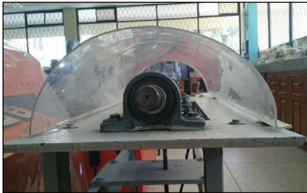
Figura 21. Cubierta plástica de protección
