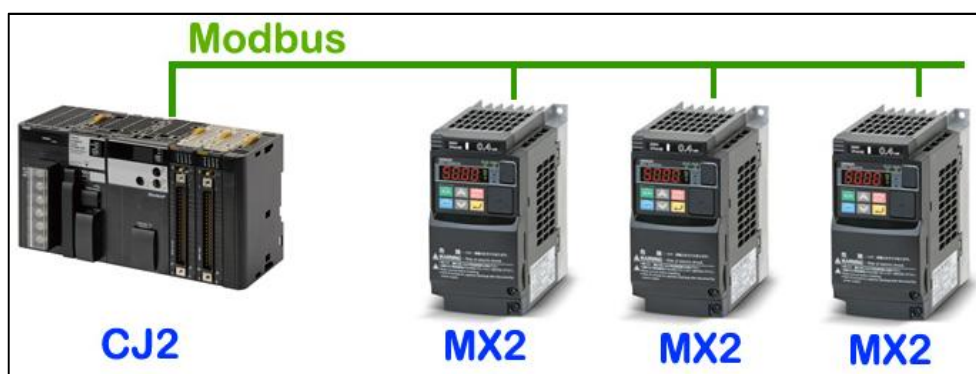
Figura 94. Comunicación de un dispositivo inteligente (PLC) con tres variadores de frecuencia
