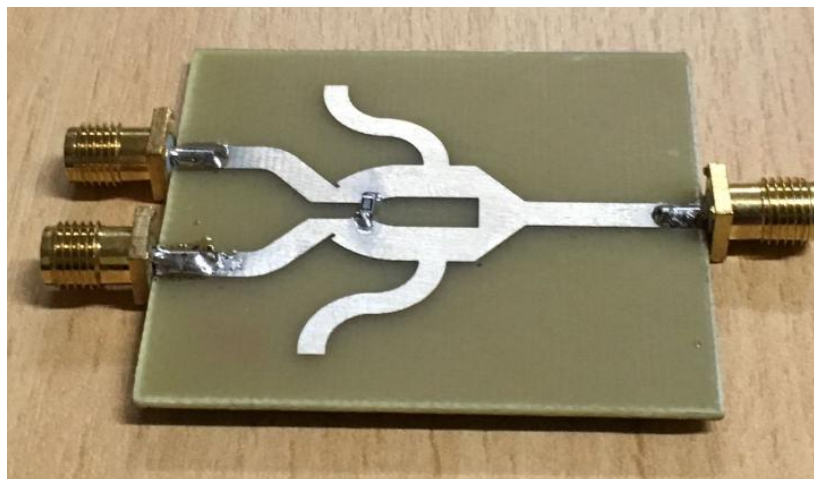
Figura 46. Divisor Wilkinson doble banda construido sobre FR-4, diseño 1.
