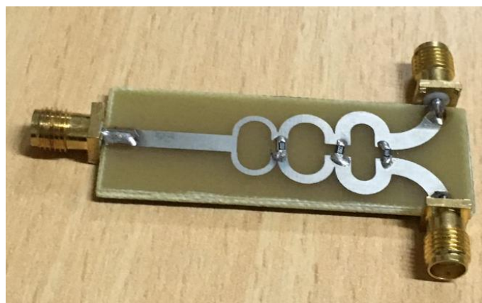
Figura 39. Divisor Wilkinson una banda de tres secciones construido sobre FR-4
