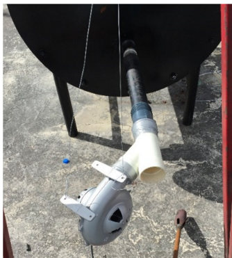
Figura 78. Pruebas de circulación con aire en el intercambiador.
