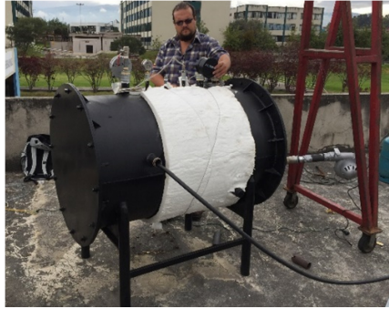
Figura 81. Llenado de la cámara del acumulador.
