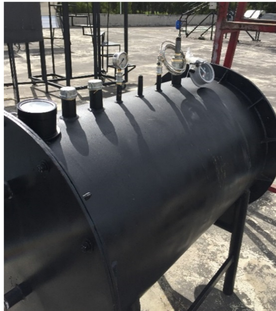
Figura 75. Instrumentos instalados en el acumulador.
