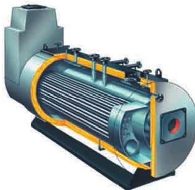
Figura 15. Caldera piro-tubular de vapor con economizador incorporado.
