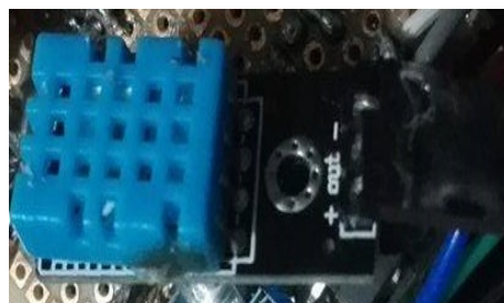
Figura 25: Conexión del sensor DHT11.
