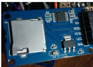
Figura 30: Conexión del módulo Micro SD.
