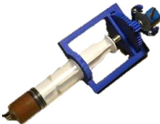
Figura 37 Mecanismo tipo jeringa para la extrusión de material
