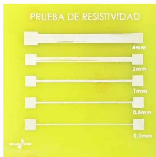
Figura 132. Placa fabricada para prueba de resistividad
