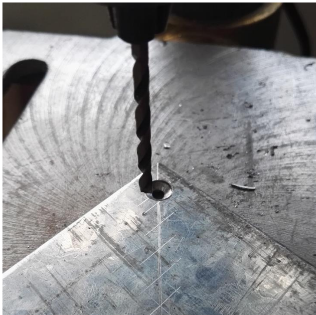
Figura 97 Construcción de platinas de presión.
