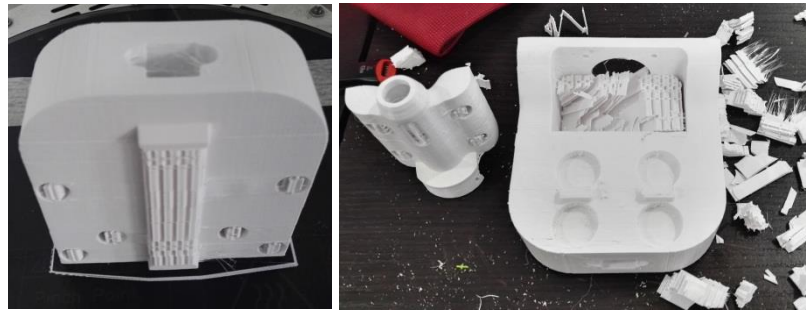
Figura 103 Limpieza de piezas impresas del extrusor
