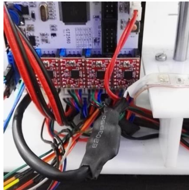
Figura 113 Conexión de placa de control con componentes de la impresora
