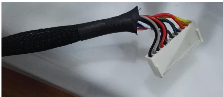
Figura 92 Conector externo para extrusor
