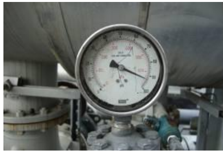
Fotografía 1: Sistema presurizado para prueba a 90 psi
