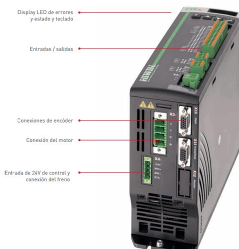
Figura 9. Elementos de conexión en un SERVOPATH
