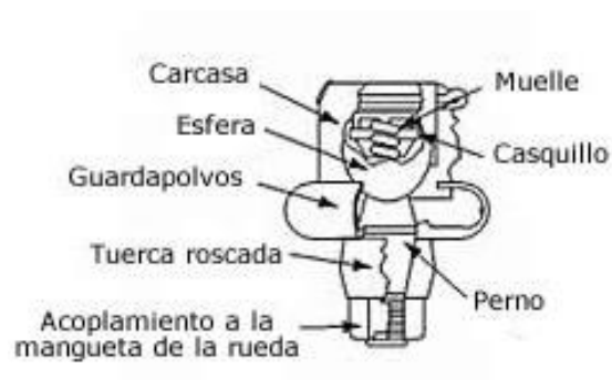
Figura 50. Partes de una rótula de dirección
