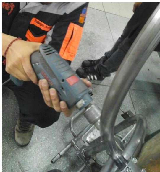
Figura 89. Taladrado de orificio para cableado
