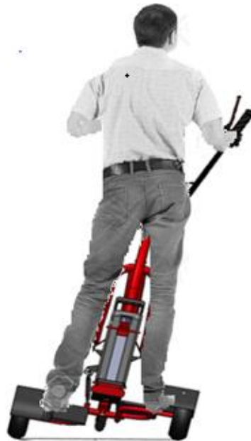
Figura 49. Sistema de estabilización en una curva
