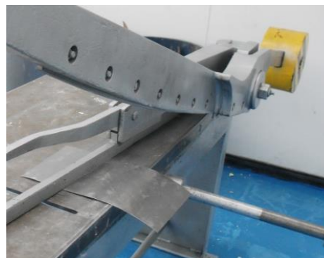
Figura 91. Corte de planchas acero A-36
