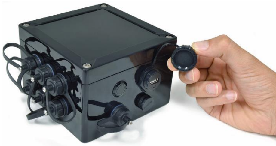
Figura 59 Abrir tapa de puerto USB Fuente: (Libelium, 2015)
