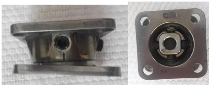
**Figura 85** Conexión adaptador – conector rotatable
