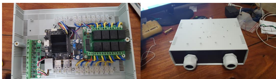
Figura 16 Muestra de la construcción y cableado del controlador CD03
