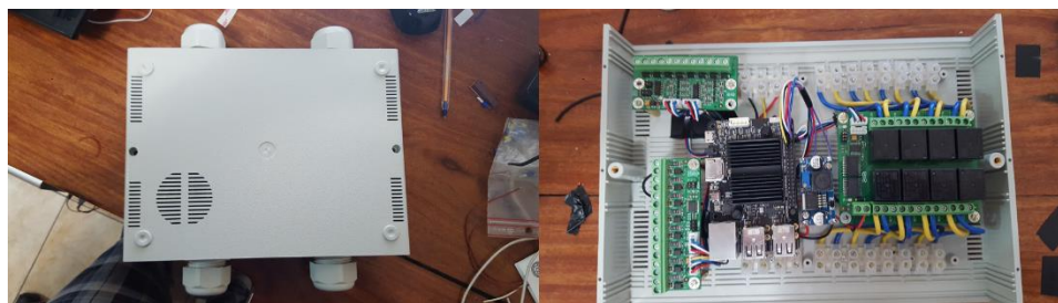
Figura 15 Muestra de la construcción y cableado del controlador CD02
