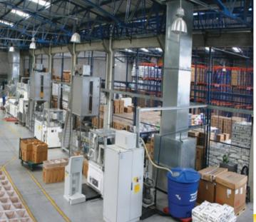
Finalmente pasa a la fase de colocación de liner (capa que garantiza la conservación de bebidas carbonatadas), lo cual comprende que las tapas vuelven a un elevador y tolva, conectándose con el ACIO quién coloca nuevamente la tapa en forma cóncava para pasar a tres carruseles, el primero para corte de liner, el segundo formación de liner y finalmente control de calidad, este último carrusel mide si la tapa cumple con la hermeticidad requerida para productos carbonatados.
