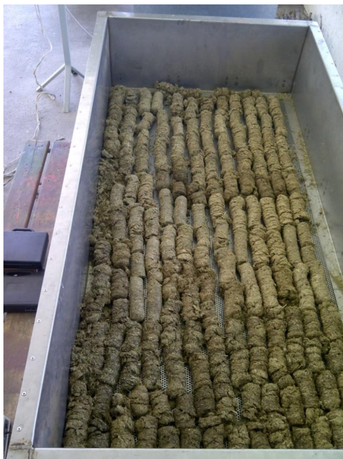
Figura 40 Secado del Pennisetum Clandestinum en estado compactado
