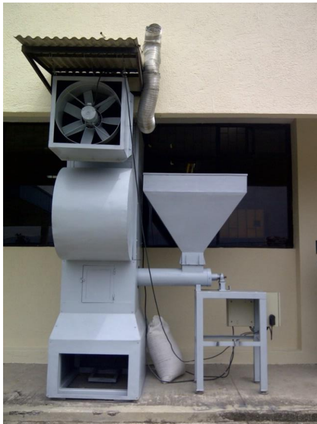
Figura 26 Horno de combustión en estado inicial
