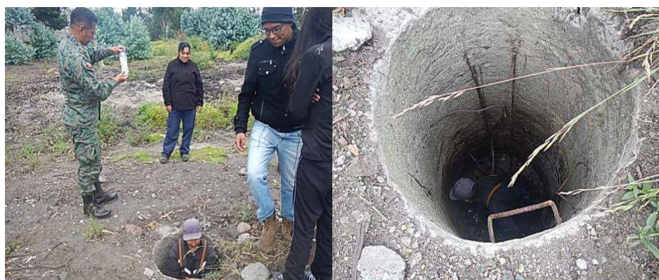
Figura 23 Toma de muestra de aguas servidas en la alcantarilla
