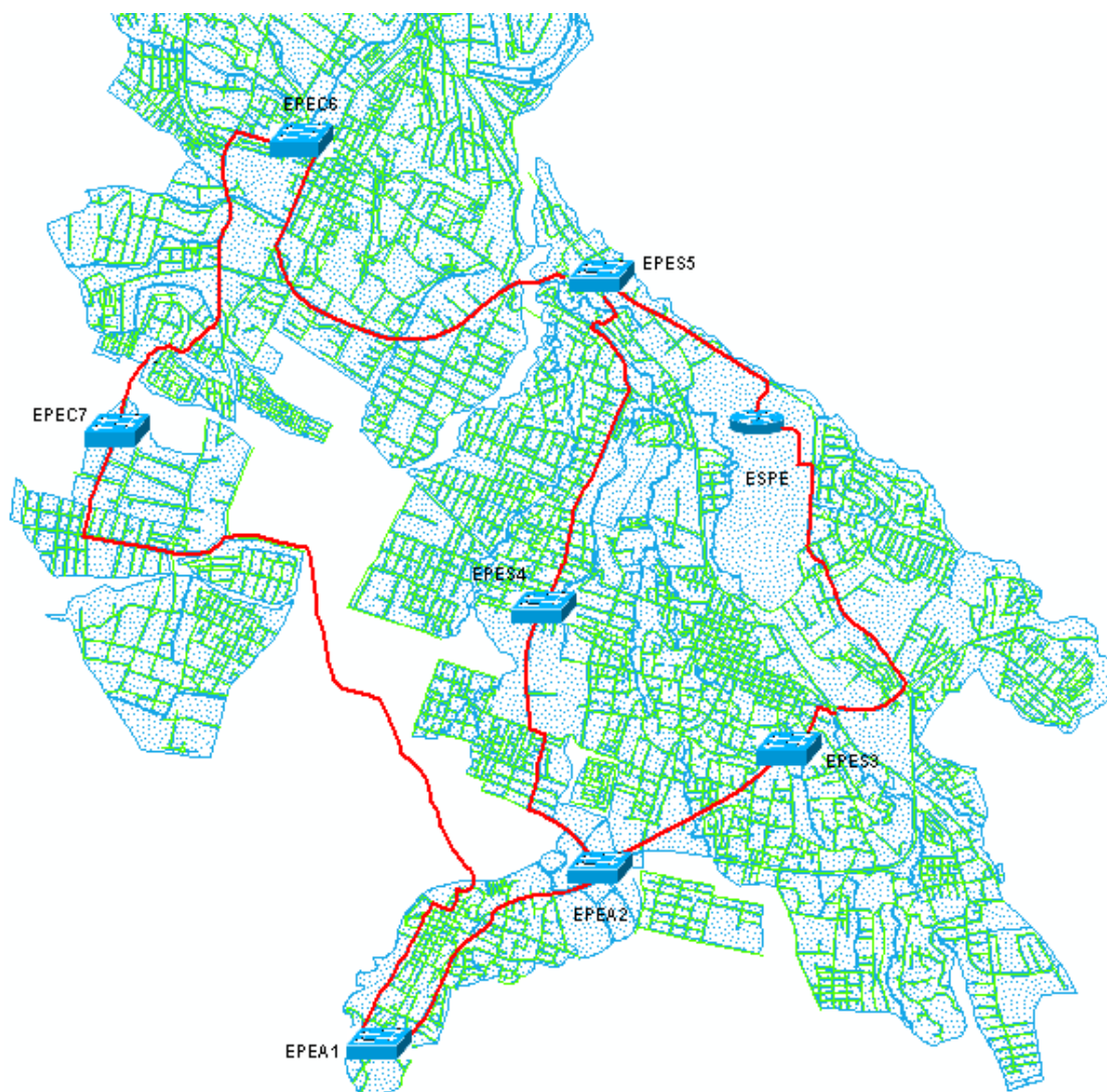
Figura 4.20. Tendido de Fibra Óptica
