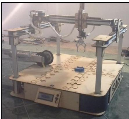
**FIGURA 2:** PRIMER PROTOTIPO DE IMPRESORA 3D CARTESIANA COMERCIAL IMPLEMENTADA
