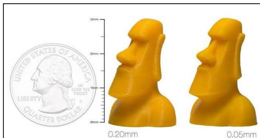
**FIGURA 24:** DIFERENTES RESOLUCIONES DE CAPA
