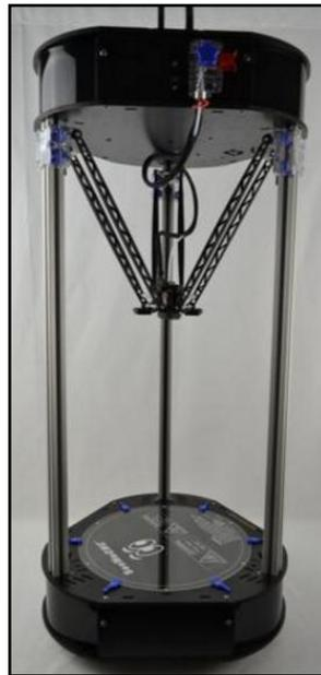
**FIGURA 77:** IMPRESORA DELTA CON CÁMARA DE IMPRESIÓN ABIERTA
