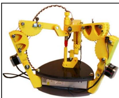
**FIGURA 12:** LA IMPRESORA 3D SIMPSON UTILIZA UN SISTEMA DE LOCOMOCIÓN DELTA TRADICIONAL
