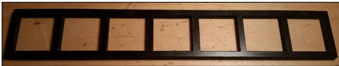
**FIGURA 156:** PRUEBAS EN MDF PARA RANURA PERFILES DE ALUMINIO EN T
