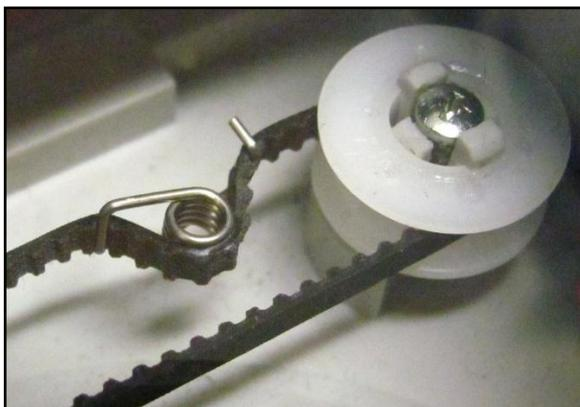
**FIGURA 59:** AJUSTADOR DE POSICIÓN VARIABLE EN CARRO
