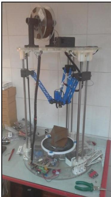
**FIGURA 4:** IMPRESORA 3D DELTA DE LA UNIVERSIDAD DE LAS FUERZAS ARMADAS—ESPE
