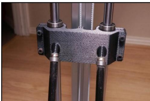
**FIGURA 51:** SISTEMA DE GUIADO CON RODAMIENTOS LINEALES
