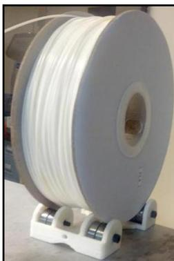
**FIGURA 73:** MANTENEDOR DE FILAMENTO RODAMIENTOS TANGENCIALES
