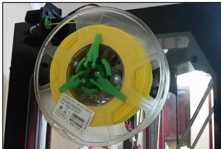
**FIGURA 178:** MANTENEDOR DE FILAMENTO IZQUIERDO
