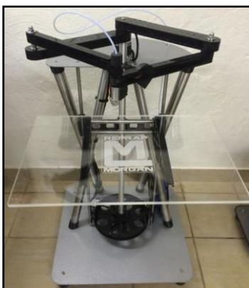
**FIGURA 11:** LA IMPRESORA 3D MORGAN UTILIZA UN SISTEMA DE LOCOMOCIÓN SCARA
