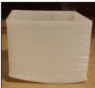
**FIGURA 21:** PROBLEMA WARPING EN IMPRESIÓN 3D CON ABS
