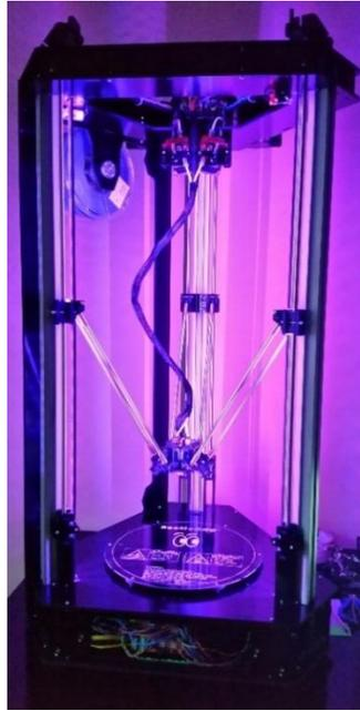
**FIGURA 169:** TERMINALES FRÍOS, PANELES LATERALES Y CABEZAL DE IMPRESIÓN, INSTALADOS
