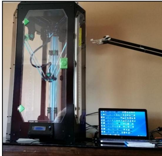
**FIGURA 173:** PANELES FINALES LATERALES E INTERFAZ DE USUARIO INSTALADOS
