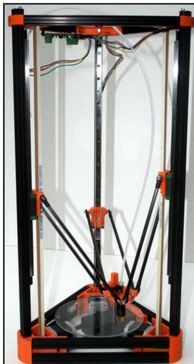
**FIGURA 76:** ESTRUCTURA TIPO KOSSSEL PARA IMPRESORA DELTA
