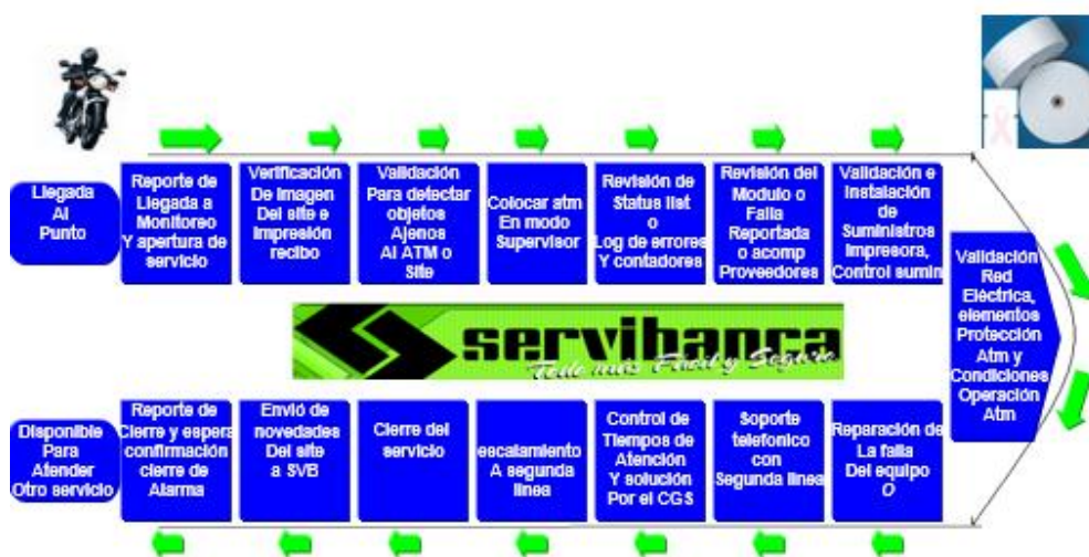
Figura 17. Mantenimiento de primera línea
