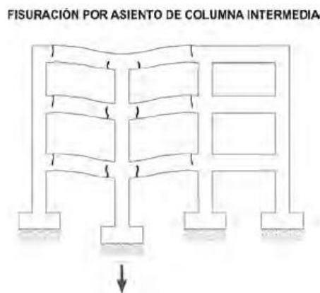
Figura 39 Fisuración por asiento de columna intermedia
