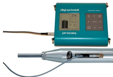
Figura 42 Martillo digital empleado en el ensayo del laboratorio DECEM
