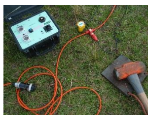
Figura 68 Martillo de golpe con sensor
