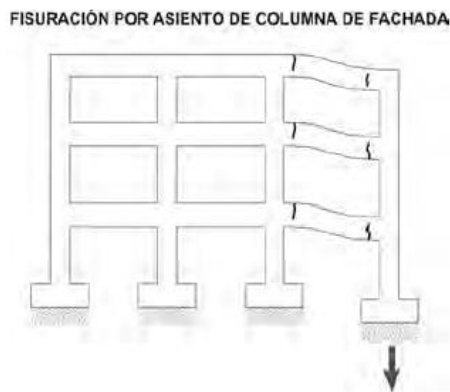
Figura 38 Fisuración por asiento de columnas de fachada
