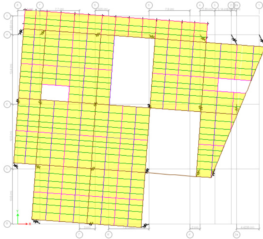
Figura 27. Tercer modo de vibrar modelo sin mampostería.
