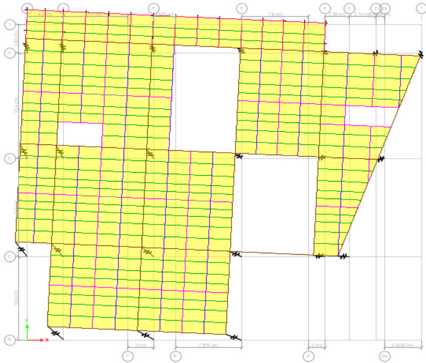
Figura 31. Primer modo de vibrar modelo incluida mampostería.
