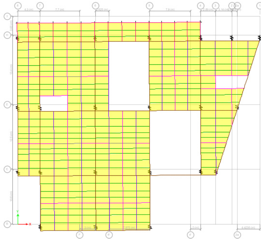
Figura 25. Primero modo de vibrar modelo sin mampostería.
