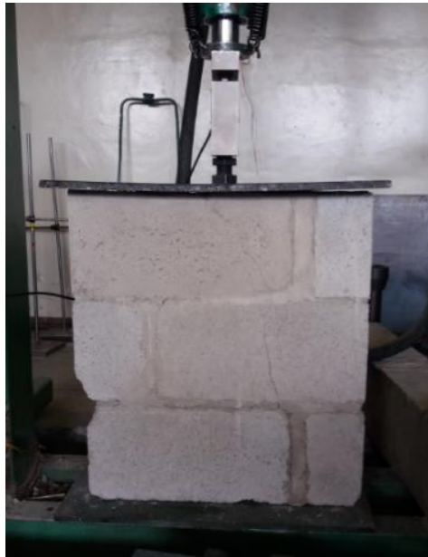
Figura 20. Agrietamiento en murete de mampostería.
