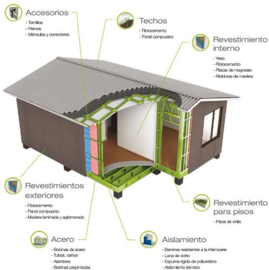
Figura 67. Sistema constructivo Steel Framing.
