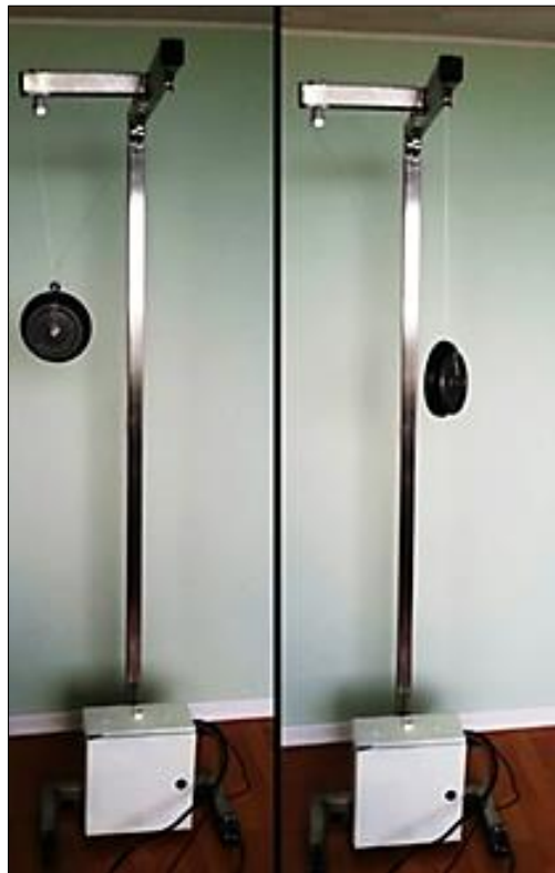
Figura 67. Proceso de prueba y validación del torque de los motores.
