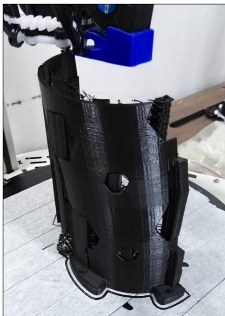
Figura 47. Proceso de impresión 3D del exoesqueleto.
