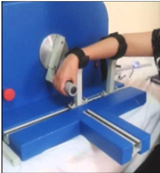
Figura 10. Prototipo de rehabilitación de codo y muñeca
