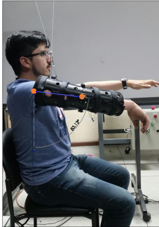
Figura 78. Pruebas de posicionamiento, brazo derecho – caso de estudio 2.
