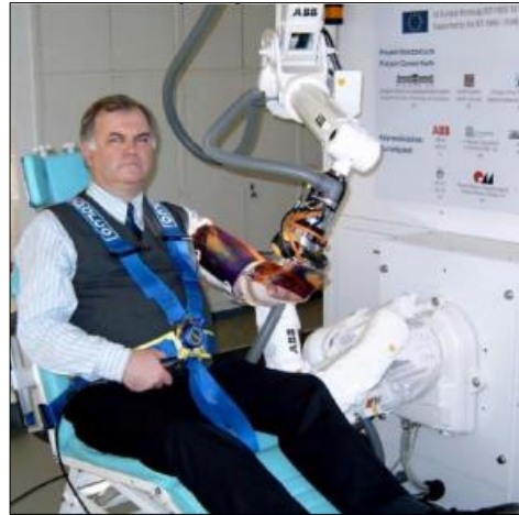
Figura 6. Robot de fisioterapia REHAROB
