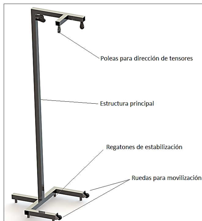
Figura 18. Esquema del diseño de la estructura de soporte.
