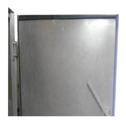
El sellador idóneo para la compuerta del horno, las condiciones del empaque o sello de vinilo del horno se verifican por inspección visual y se determina que no requiere cambio, aún más cuando se fundamenta en el hecho de los procesos de mantenimiento que se han generado en la empresa que hicieron posible pensar que no es necesario el cambio de este elemento.
