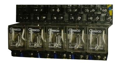
Los temporizadores se comportan de forma parecida a los relés, pero tienen un control de tiempo para retardar el funcionamiento de algo, hacer que funcione con tiempos de marcha y paro, o retrasar la desconexión de algo. Se pueden activar por alimentación o por pulsador, según la necesidad del circuito
