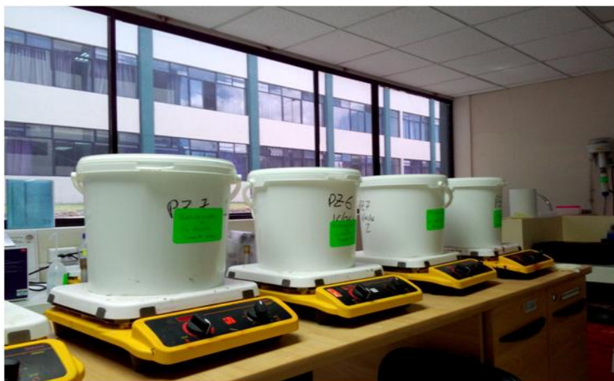
Figura 10: Contenedores de 10 litros con pre-flóculo de leche descremada en agitación por 8 horas a temperatura ambiente.
