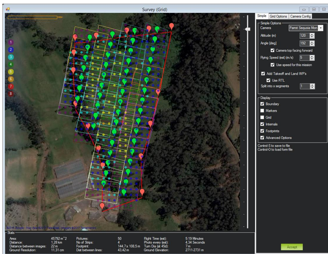
Figura 22, Plan de vuelo en el software Mission Planner
