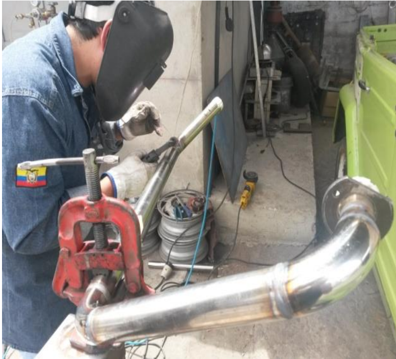
Figura 39 Acabados finales del colector de escape
