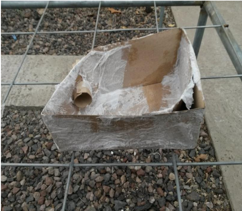
Figura 32 Molde primario realizado en cartón y papel de cocina
