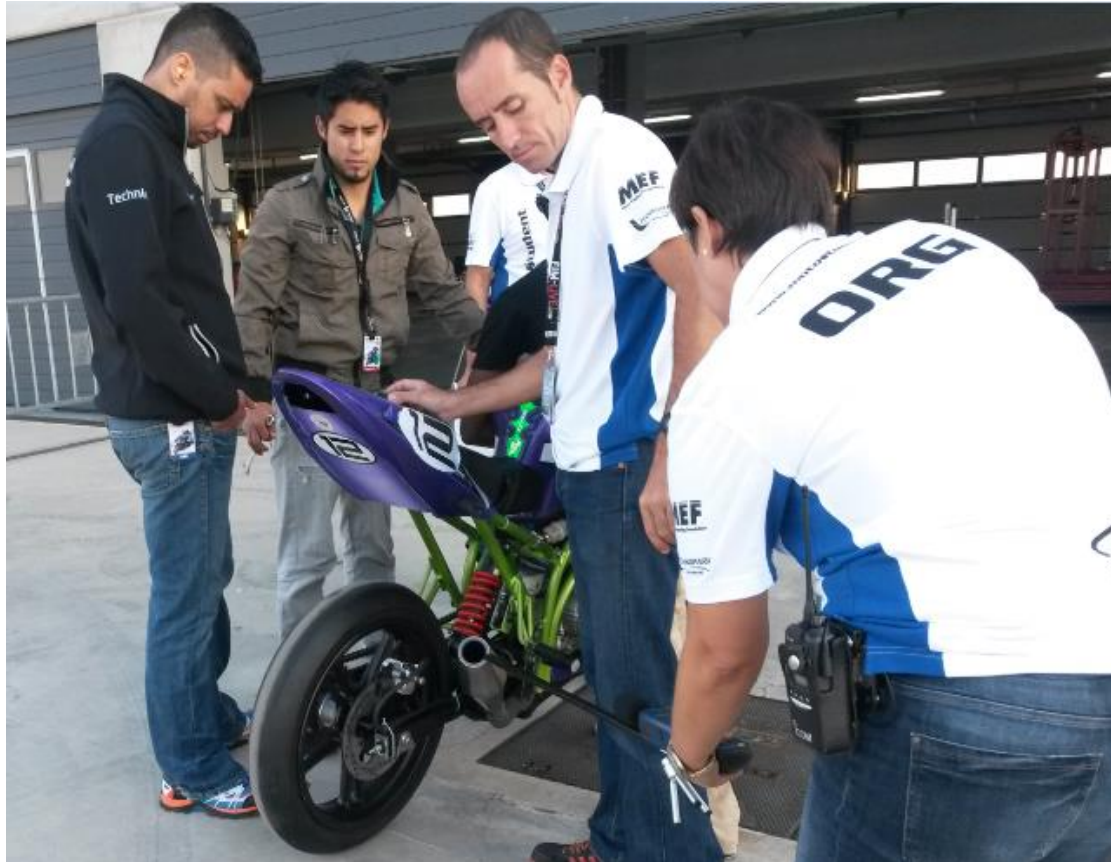
Figura 48 Inspección de sonoridad del escape
