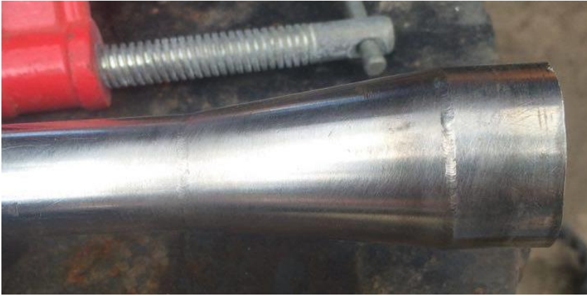
Figura 30 Acabado final del proceso de soldadura tubería de 1plg
