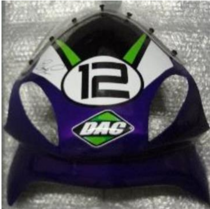
Figura 24 Carenado frontal con tomas aire
