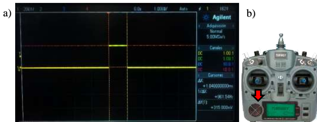
Figura 72. a) Posición mínima del Stick Acelerador b) Señal PWM Canal # 3 / Acelerador nivel mínimo (100% Abajo).
