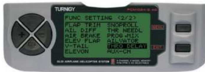
Figura 32. Programación de la mezcla de canales del modo de vuelo en el transmisor.
