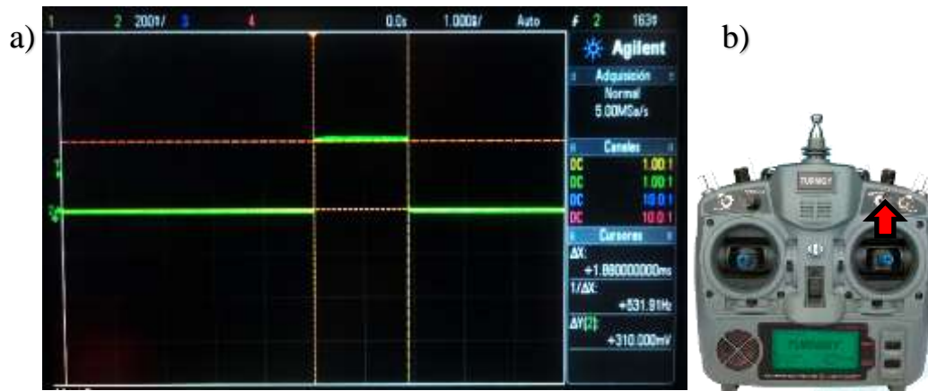
Figura 70. a) Posición máxima del Stick Elevador b) Señal PWM Canal # 2 / Elevador nivel máximo (100% arriba).
