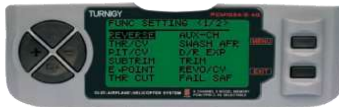
Figura 30. Canales auxiliares del modo de vuelo en el transmisor Turnigy 9X.
