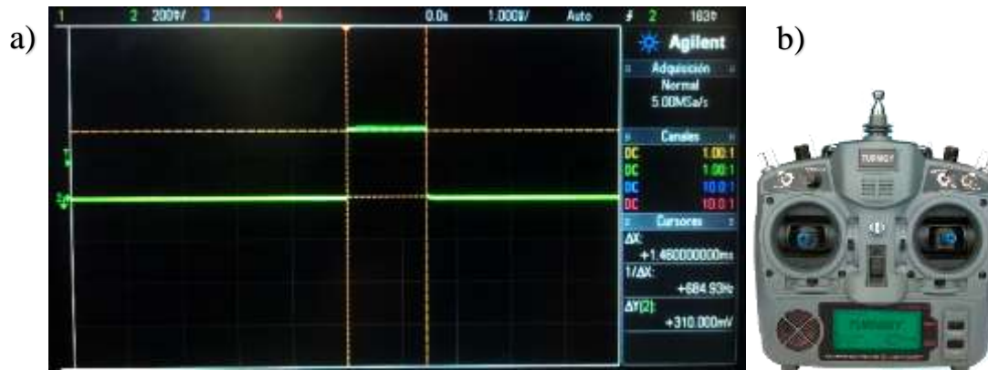
Figura 69. a) Posición medio del Stick Elevador b) Señal PWM Canal # 2 / Elevador nivel medio (50 %).
