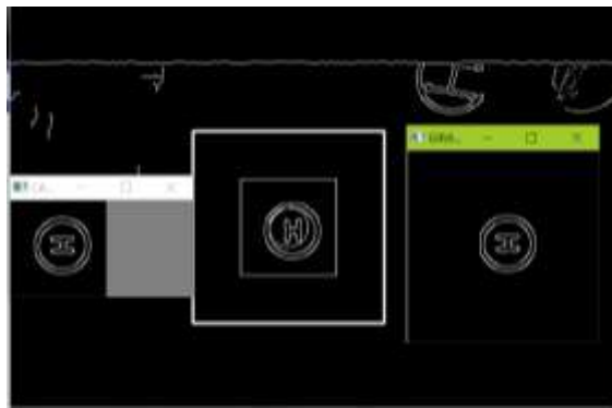
Figura 92. En la sub ventana de color verde se observa la imagen capturada y girada (200x200 pixeles) mientras que en la ventana de color blanco se visualiza la imagen ROI (100x100 pixeles capturada de la imagen de 200 x 200).
