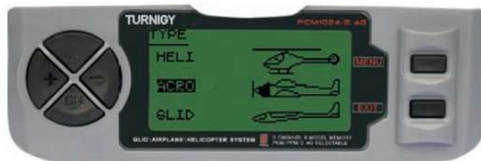
Figura 26. Tipo de aeronave para sistema de vuelo en el transmisor Turnigy 9X.
