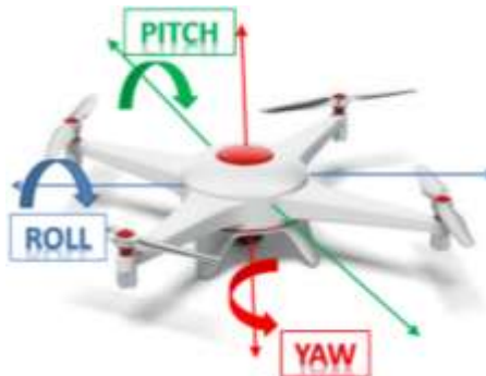
Figura 18. Ejes de giro presentes en un cuadricóptero.
