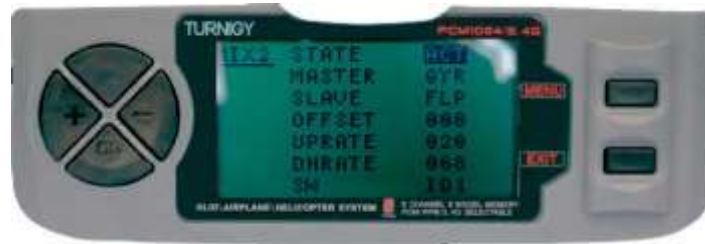
Figura 34. Programación del MIX 2 del modo de vuelo en el transmisor Turnigy 9X.
