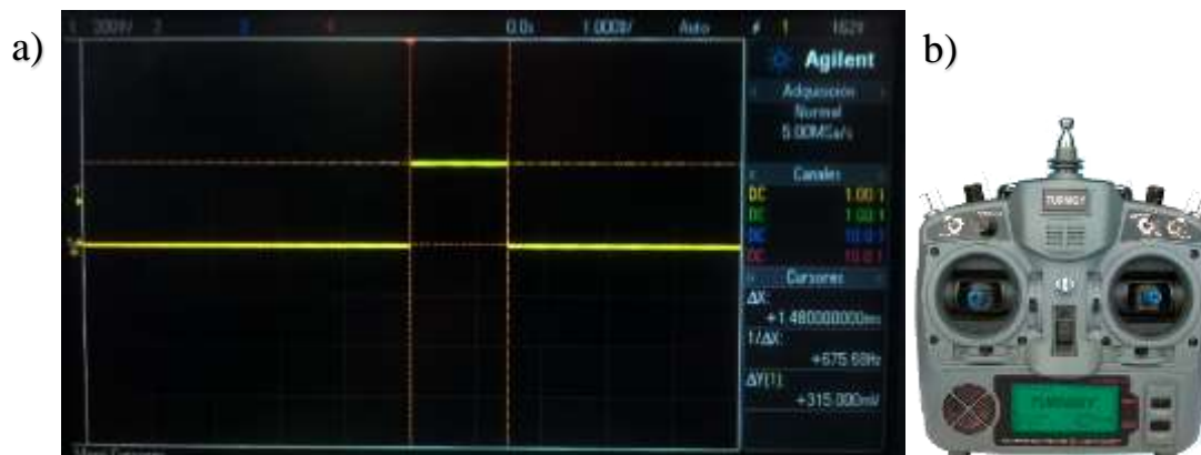
Figura 73. a) Posición media del Stick Acelerador b) Señal PWM Canal # 3 / Acelerador nivel medio (50%).
