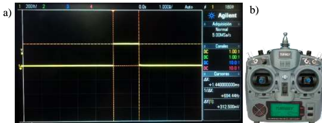
Figura 65. a) Posición mínima del Stick Alerón b) Señal PWM Canal # 1 / Alerón nivel medio (Stick 50%).
