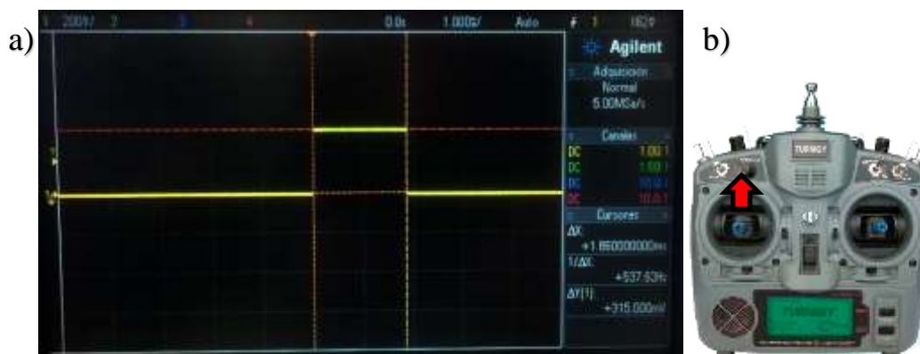
Figura 74. a) Posición máxima del Stick Acelerador b) Señal PWM Canal # 3 / Acelerador nivel máximo (100% Arriba).
