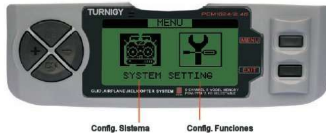
Figura 29. Categoría “SYSTEM” del modo de vuelo en el transmisor Turnigy 9X.
