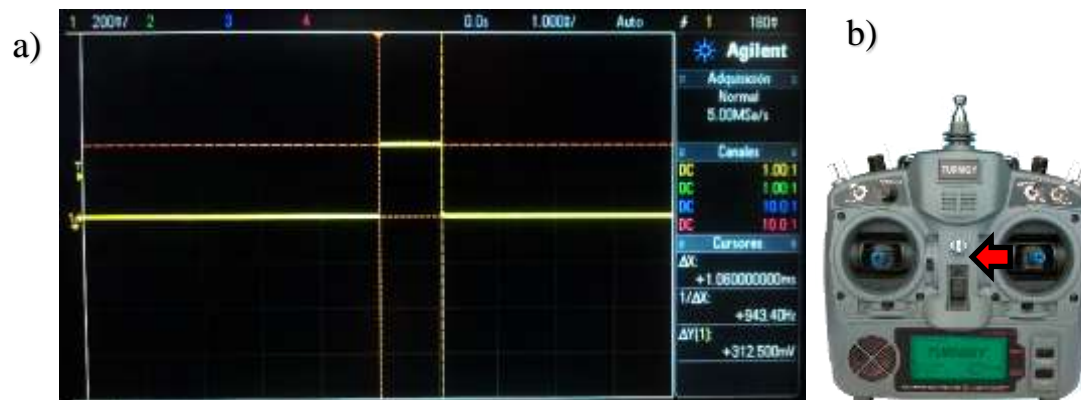
Figura 64. Posición mínima del Stick Alerón b) Señal PWM Canal # 1 / Alerón nivel mínimo (Stick 100% izquierda).
