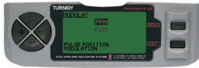
Figura 27. Tipo de modulación del receptor en el transmisor Turnigy 9X.
