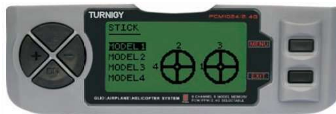
Figura 28. Modo de distribución de los Sticks para el sistema de vuelo en el transmisor.
