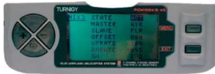
Figura 35. Programación del MIX 3 del modo de vuelo en el transmisor Turnigy 9X.
