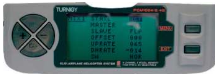
Figura 33. Programación del MIX1 del modo de vuelo en el transmisor Turnigy 9X.
