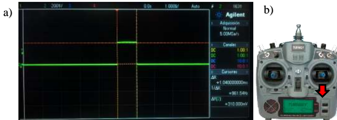
Figura 68. a) Posición mínima del Stick Elevador b) Señal PWM Canal # 2 / Elevador nivel mínimo (100% Abajo).
