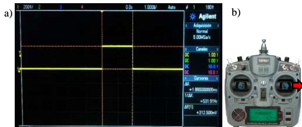
Figura 66. a) Posición media del Stick Alerón b) Señal PWM Canal # 1 / Alerón nivel máximo (Stick 100% derecha).
