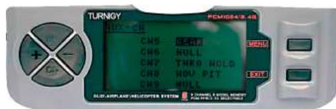
Figura 31. Configuración de canales 5,6,7,8,9 en el transmisor Turnigy 9X.
