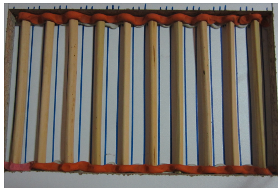
Figura 30 Sujeción y elevación de fibra de totora mediante plastilina.
