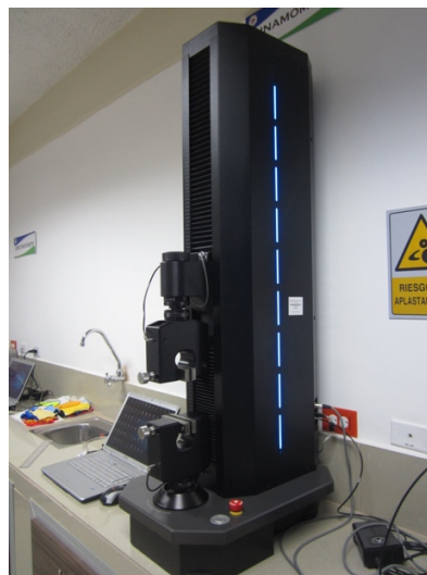
Figura 31 Máquina de ensayos universal James Heal del laboratorio de textil de la Universidad Técnica del Norte-Ecuador
