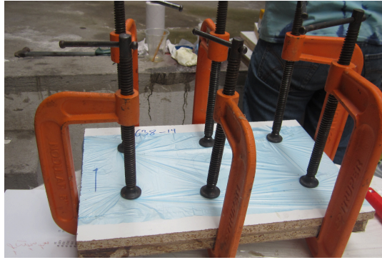
Figura 28 Prensado de moldes para obtención de probetas.
