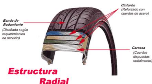
Figura 43. Estructura radial del neumático
