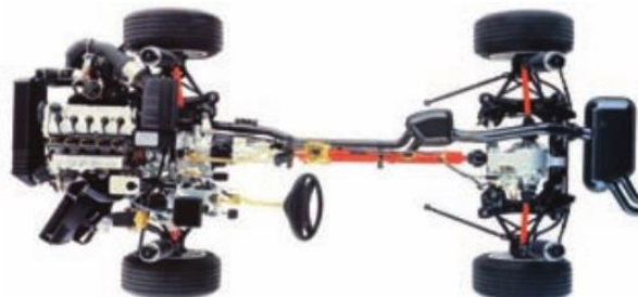
Figura 37. Conjunto motor, cambio y transmisión del Audi Quattro
