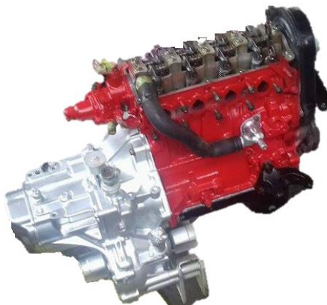
Figura 76. Caja de cambios implementada en el prototipo
