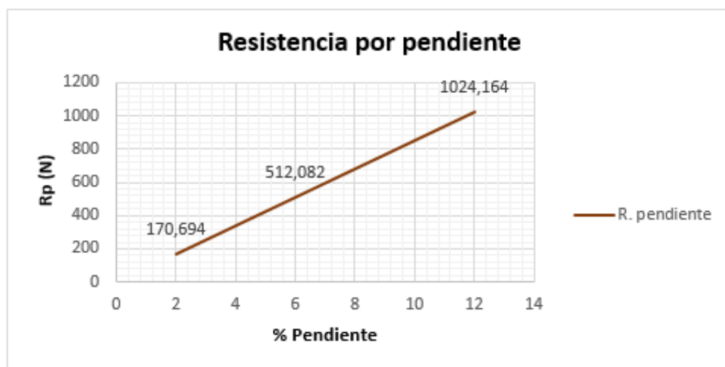
Figura 67 Resistencia por pendiente a plena carga
