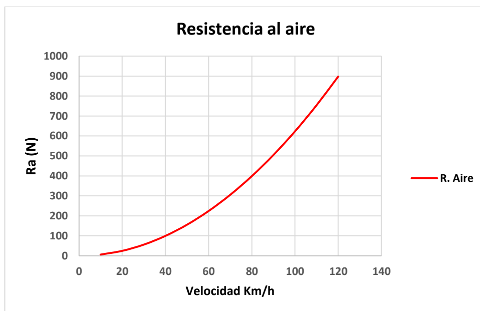
Figura 63. Resistencia al aire a plena carga
