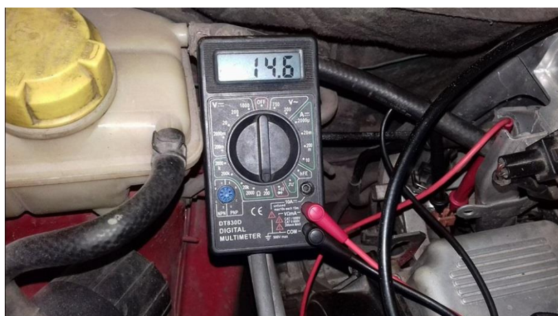
Figura 87. Resistencia de la bobina del inyector
