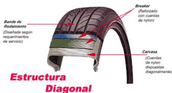
Figura 42. Estructura diagonal del neumático
