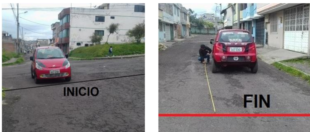
Figura 99. Prueba de distancia de frenado en asfalto
