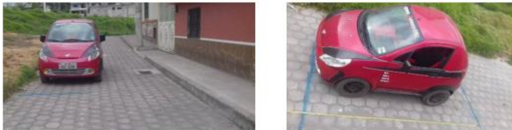
Figura 100. Prueba de distancia de frenado en adoquín
