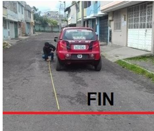
Prueba de distancia de frenado en asfalto
