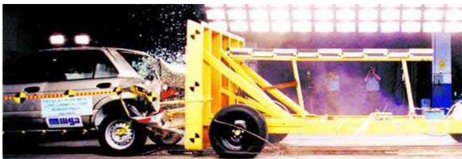
Figura 14 Impacto posterior a un vehículo según EuroNCAP
