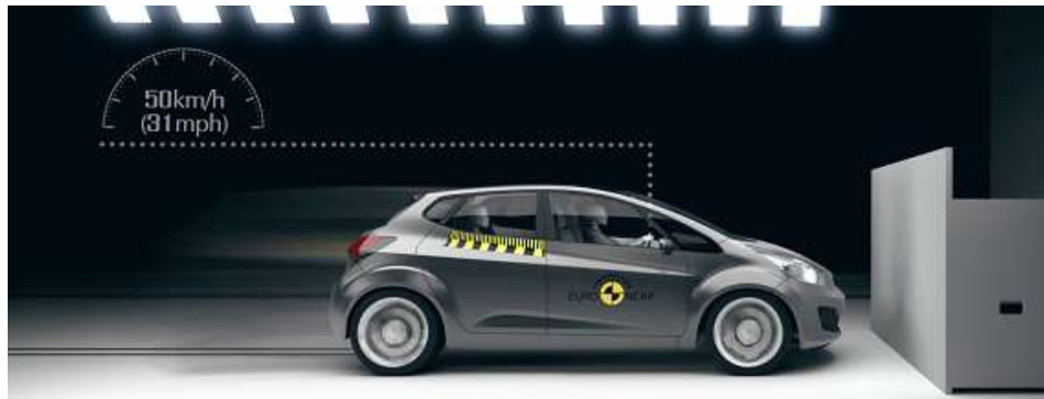
Figura 13 Prueba de impacto frontal EuroNCAP
