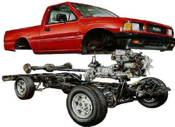
Figura 1 Carrocería y chasis independientes
