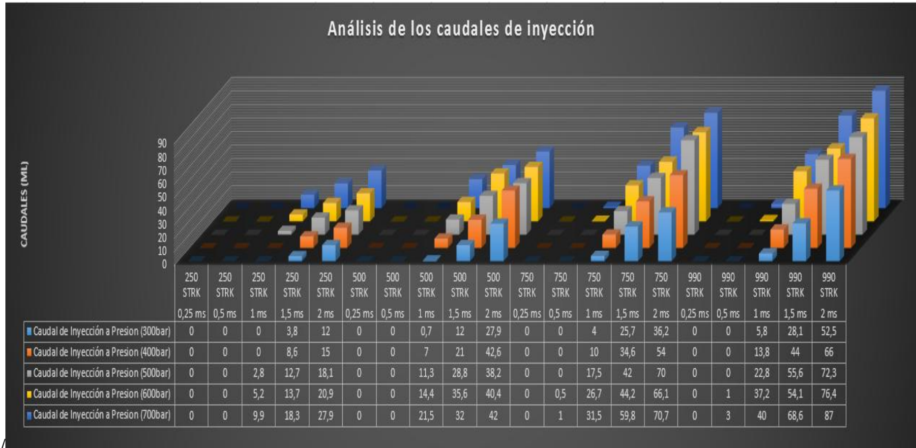
Figura 45. Análisis de los caudales de inyección con la variación de pulsos y el tiempo de inyección a presiones (300, 400, 500, 600, 700) bar, según los datos de la tabla 37.
