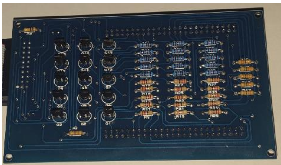
Figura 38 Hardware terminado para interpretación de datos de sensores
