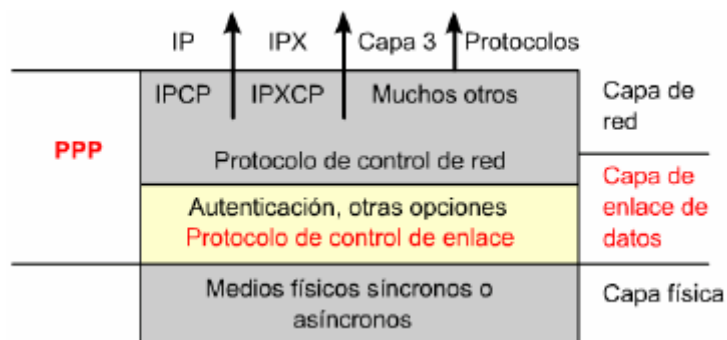
Figura 1.22 PPP proceso de capas OSI
