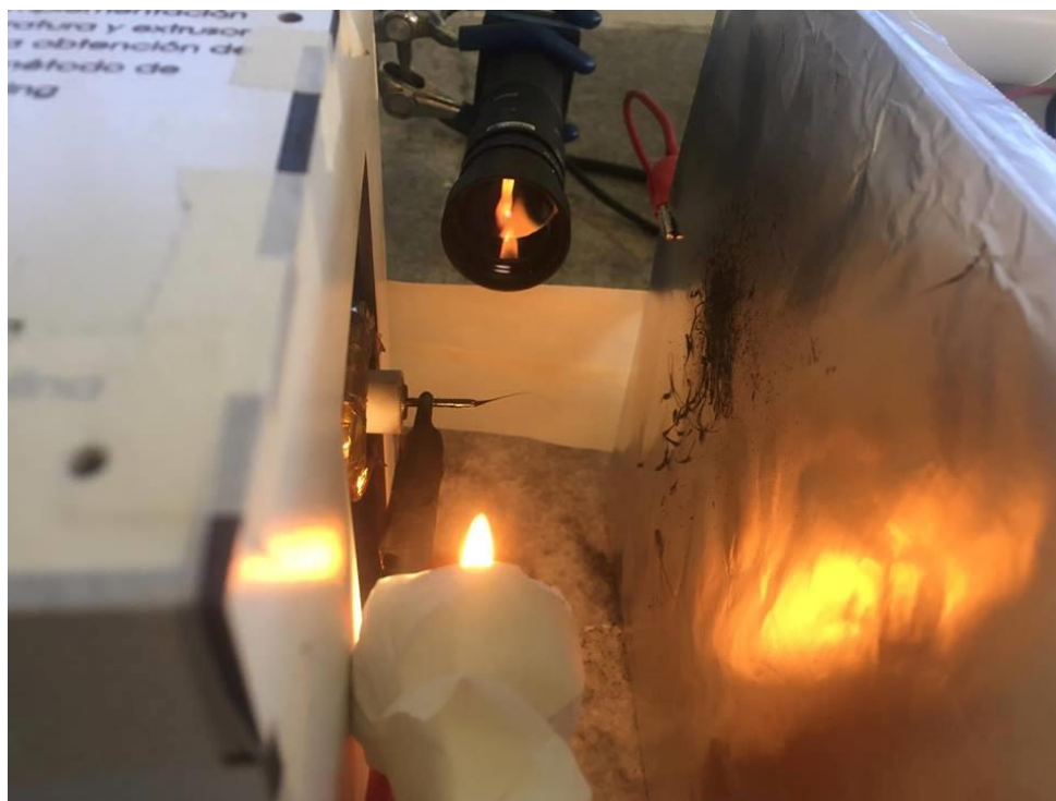
Figura 88 Proceso de electrospinning con IPP
