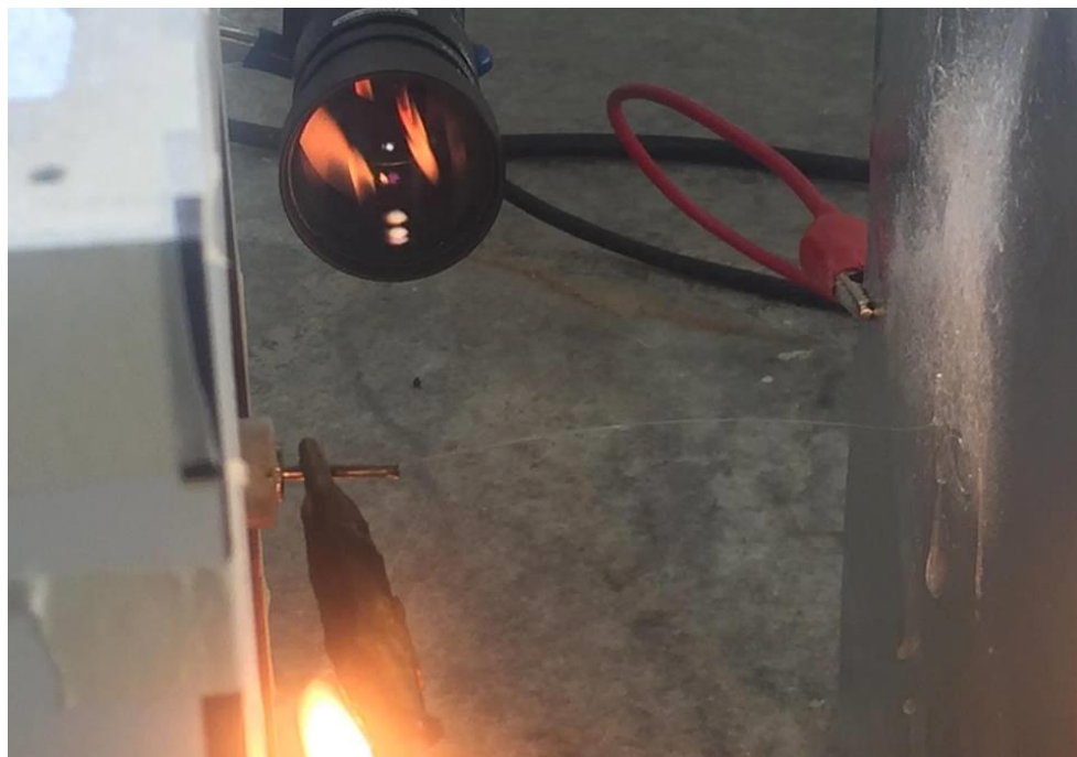
Figura 82 Proceso de electrospinning con APP
