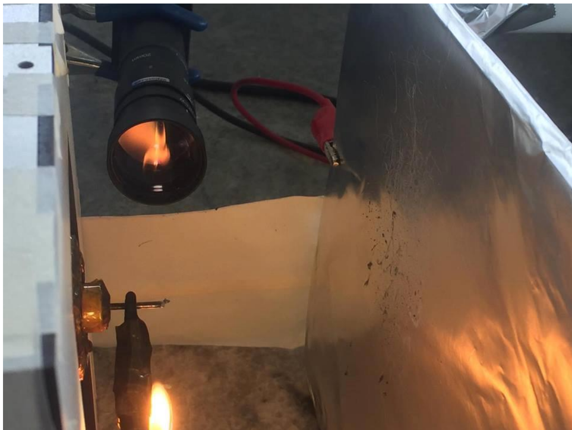
Figura 93 Proceso de electrospinning con LDPE
