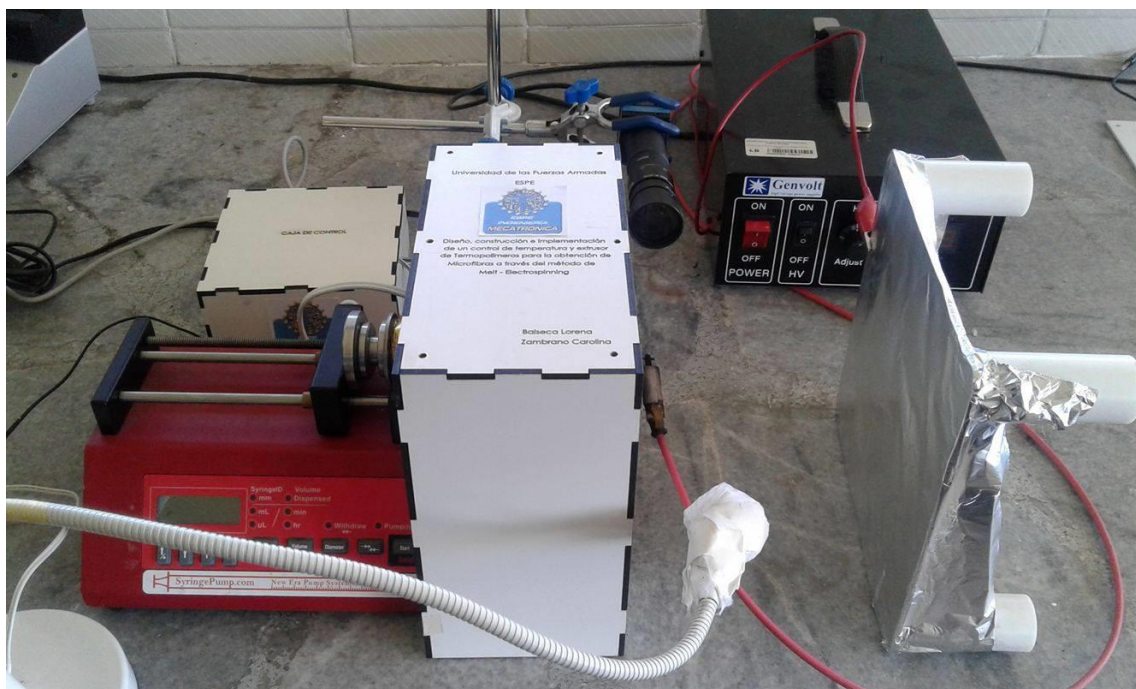
Figura 70 Implementación del sistema extrusor
