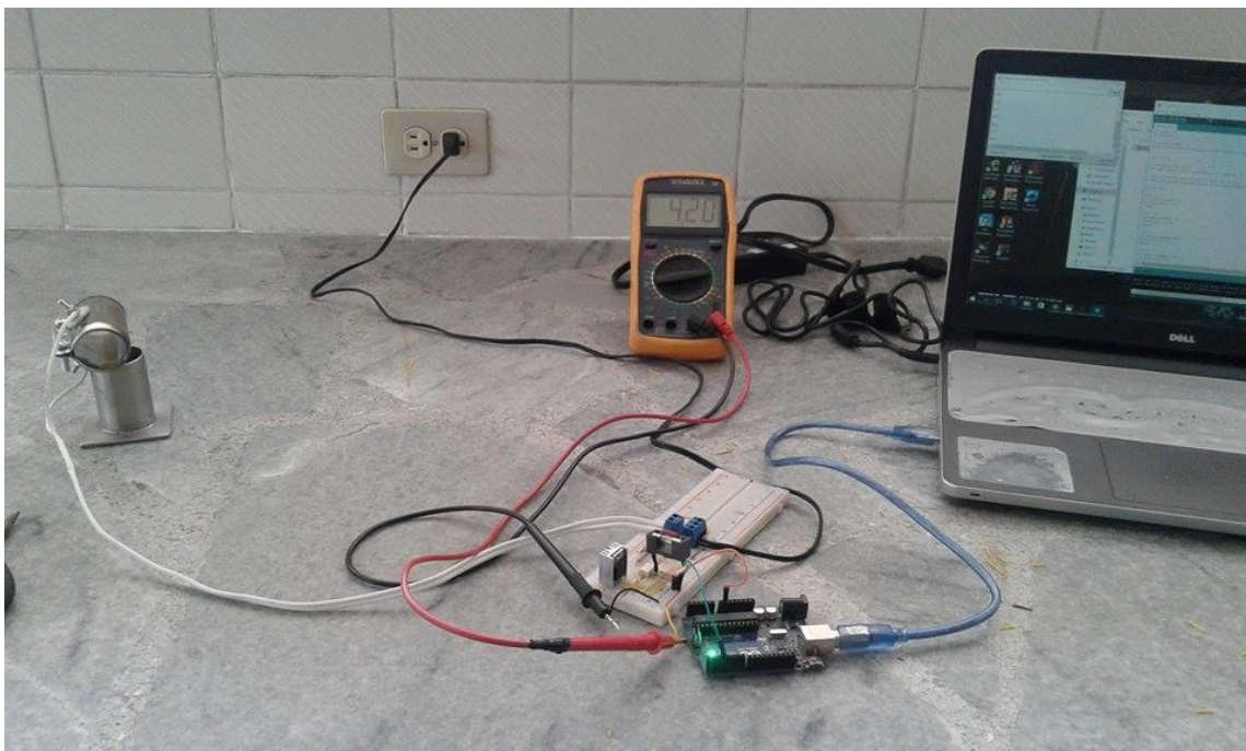
Figura 67 Comprobación del funcionamiento del circuito de potencia
