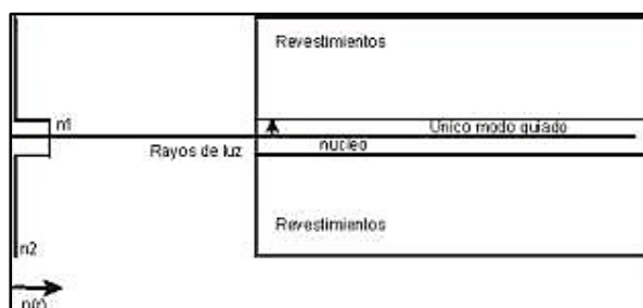
Figura 46 Luz En El Interior De La Fibra Óptica Monomodo
