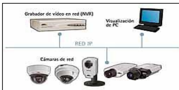
Figura 23 Sistema De Cámara Con Plataforma NVR
