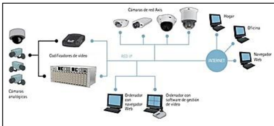
Figura 25 Sistema De Vigilancia Con Servidor De Video
