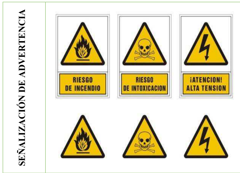
Figura 18 Señalización de advertencia
