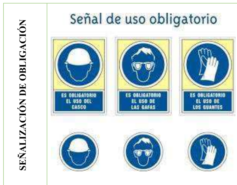
Figura 17 Señalización de obligación
