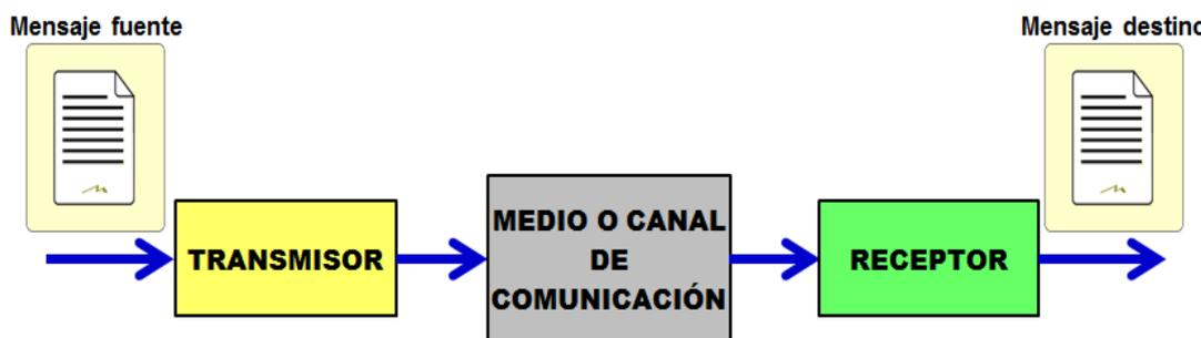
**Figura 1 Elementos de un sistema de comunicación**
