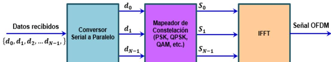
**Figura 12 Transmisor OFDM utilizando IFFT**
