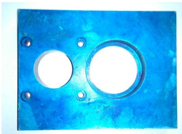
**Figura N° 67. Falla en el anodizado**
