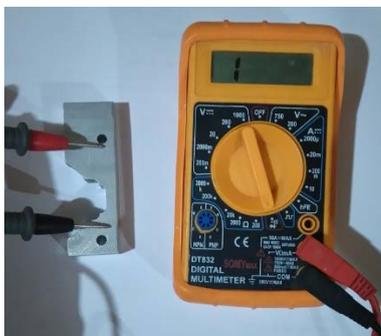
**Figura N° 58. Prueba de continuidad en pieza anodizada**
