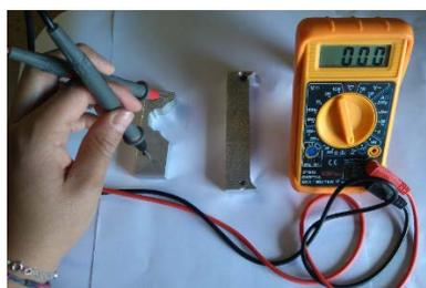
**Figura N° 54. Prueba de continuidad de la pieza**
