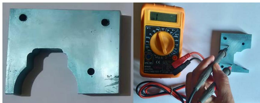
**Figura N° 60. (a) Pieza terminada (b) Prueba de continuidad en la pieza 1**
