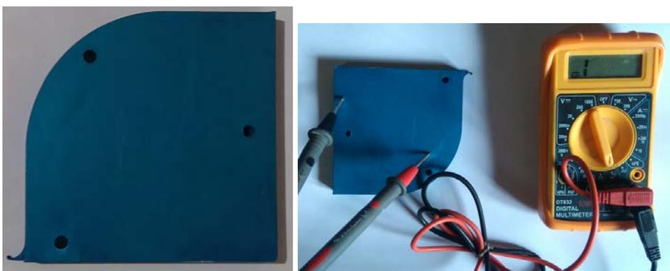
**Figura N° 66. (a)Pieza terminada (b) Prueba de continuidad en la pieza 4**
