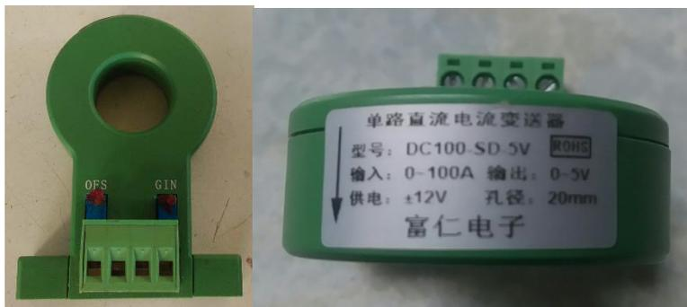
**Figura N° 14. Sensor de corriente de efecto hall**
