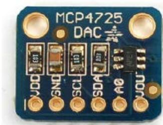
**Figura N° 13. Conversor Digital-Análogo MCP4725**
