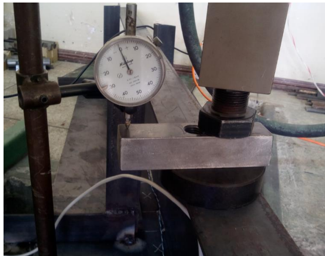
Figura 63. Aplicación de la carga en la viga
