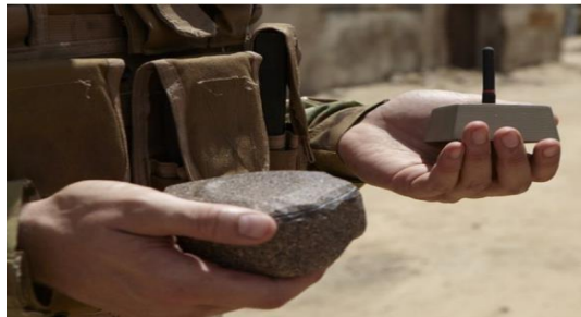
Figura 26. Piedra espía como nodo sensor.
