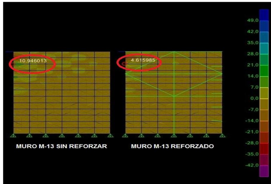
**Figura 120.** Comparación de esfuerzos a compresión S11 en muro M-13
