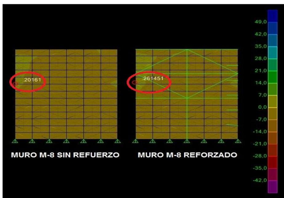
**Figura 119.** Comparación de esfuerzos a compresión S11 en muro M-8
