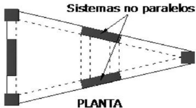
**Figura 12. Ejes estructurales no paralelos**
