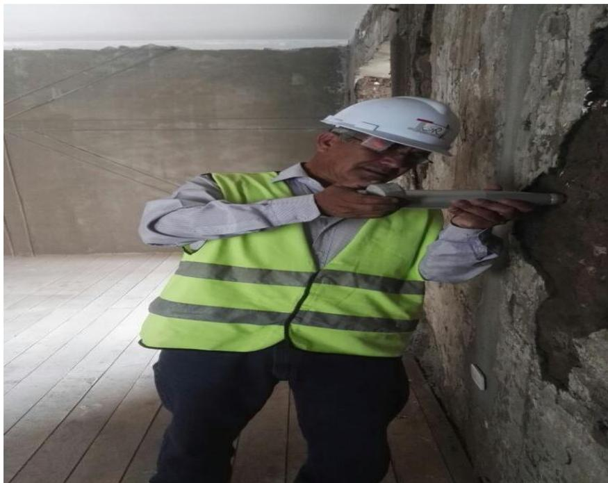
**Figura 58.** Medición con martillo de rebote en bloque central
