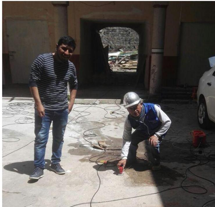
**Figura 40.** Instalación de geófonos y tendido sísmico
