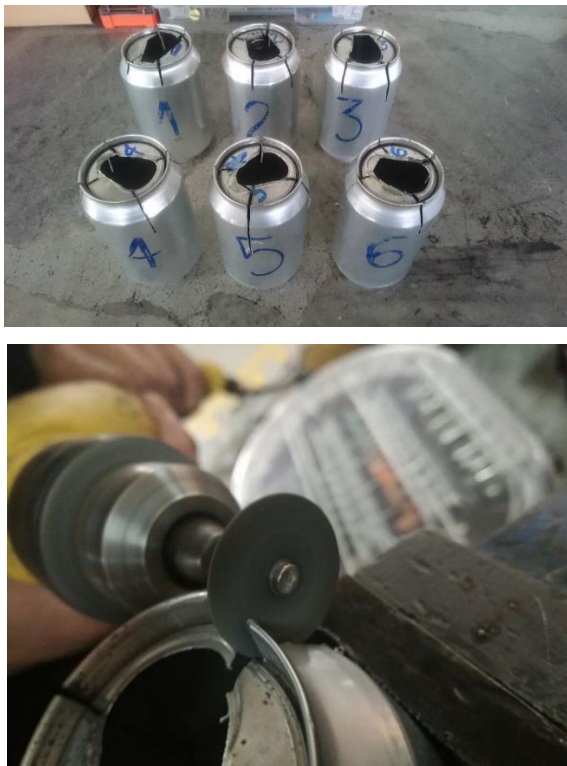
Figura 52 Desmontaje del cierre
